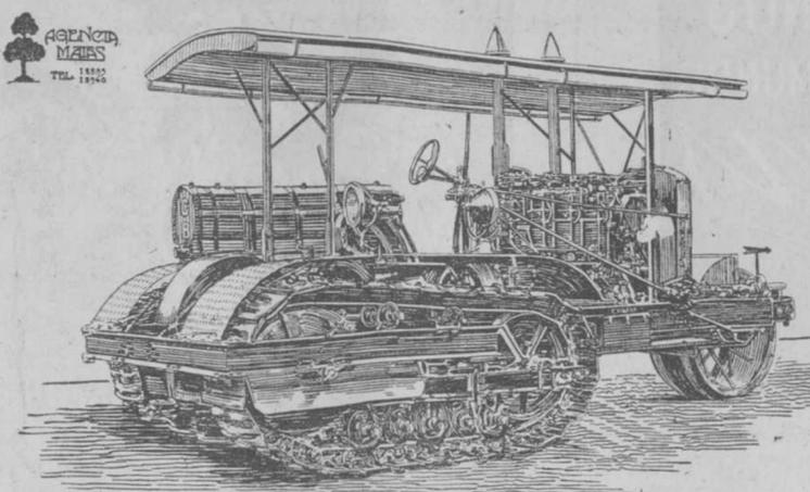
Esta máquina trabaja con un producto que cuesta 20 centavos el galón, consumiendo 40 de éstos en diez horas. También trabaja con gasolina. Todas las piezas de esta máquina sujetas a fricción y gran resistencia, son fabricadas de acero níquel o acero cromo. Por esta razón no hay desgastes ni roturas frecuentes. Es la máquina de arar más perfecta que se conoce y en cuanto a potencia garantiza el 60 por 100 a la barra de tracción.
