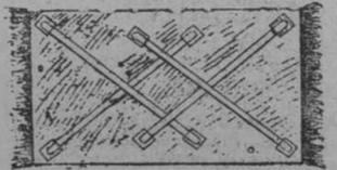
tas de acero de algunas décimas de milímetro de espesor, articuladas á modo de ballesta y dispuestas en la forma que indica la figura. Dichos tensores se fijan en el reverso de la alfombra, encajando la extremidad de las cintas metálicas en ocho bolsillos construidos expresamente.
