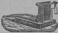
Puente báscula viícola. - Nuevo sistema de caja metálica, colocándose á flor de tierra para facilitar el pesado de los toneles colocados encima en cualquier sentido.
