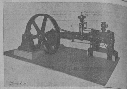
Maquina de vapor, sistema Corliss, proyectada y construída en los tallelles d la Escuela de Artes e Industrias de Santander.—(De fotografía obtenida con objetivo calculado por un profesor de dicha Escuela y fabricado en la mism
