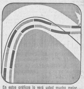
En estos gráficos lo verá usted mucho mejor. En éste, por las mismas señales se va notando cómo la adherencia de un coche con malos amortiguadores pasa alternativamente de un lado a otro, hasta que fué imposible hacerse con él.
