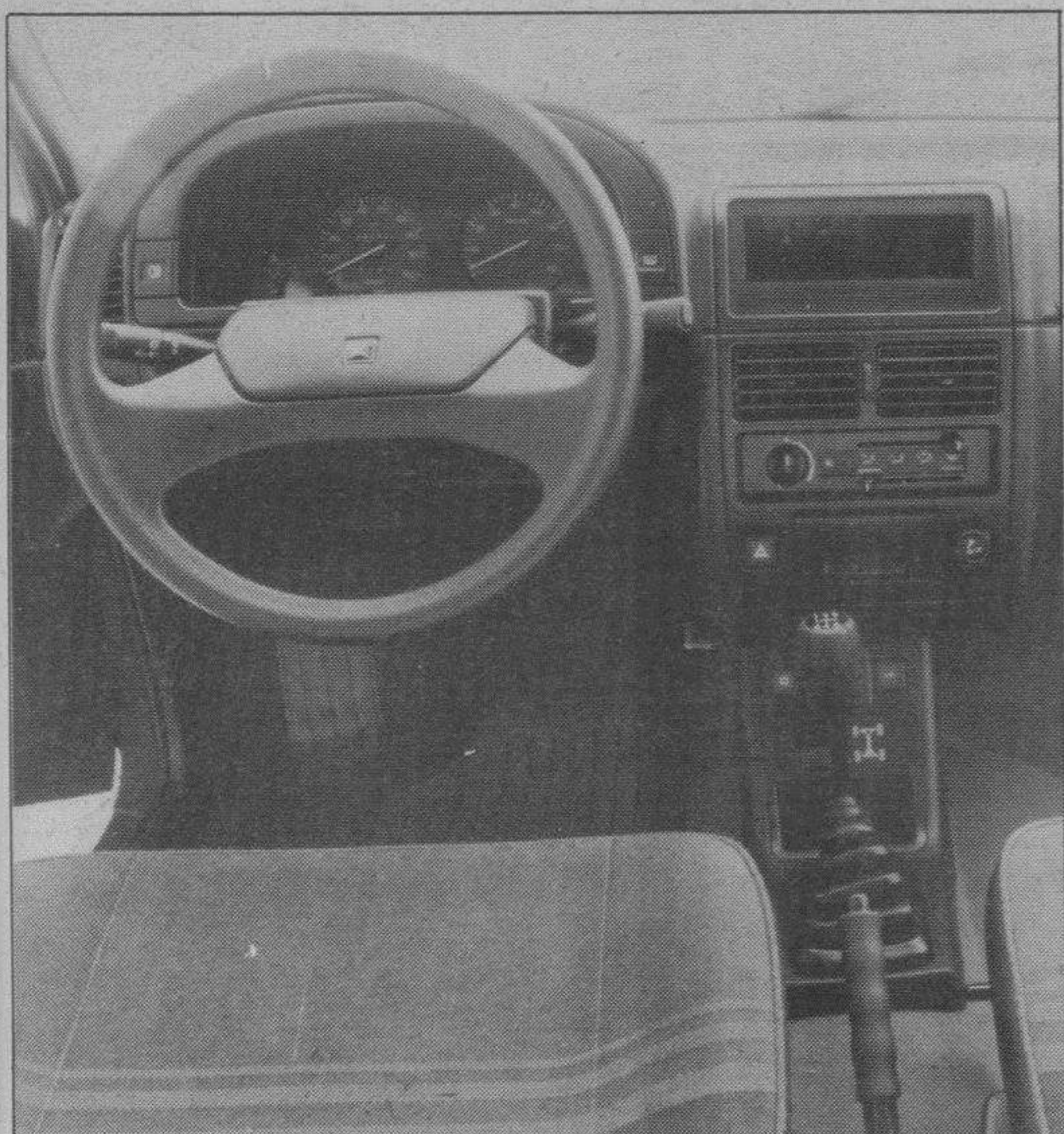
En el inferior de la consola está el interruptor y testigo luminoso del tipo de tracción. El hielo y nieve no son obstáculo para el AX 4x4. (Foto: DB)
