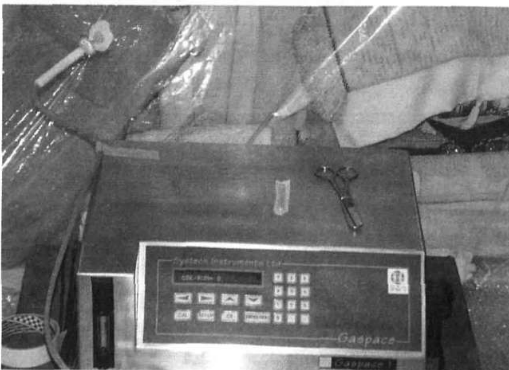
Foto n° 5. Oxímetro, se pueden apreciar las válvulas selladas con masilla y las sondas de control.
