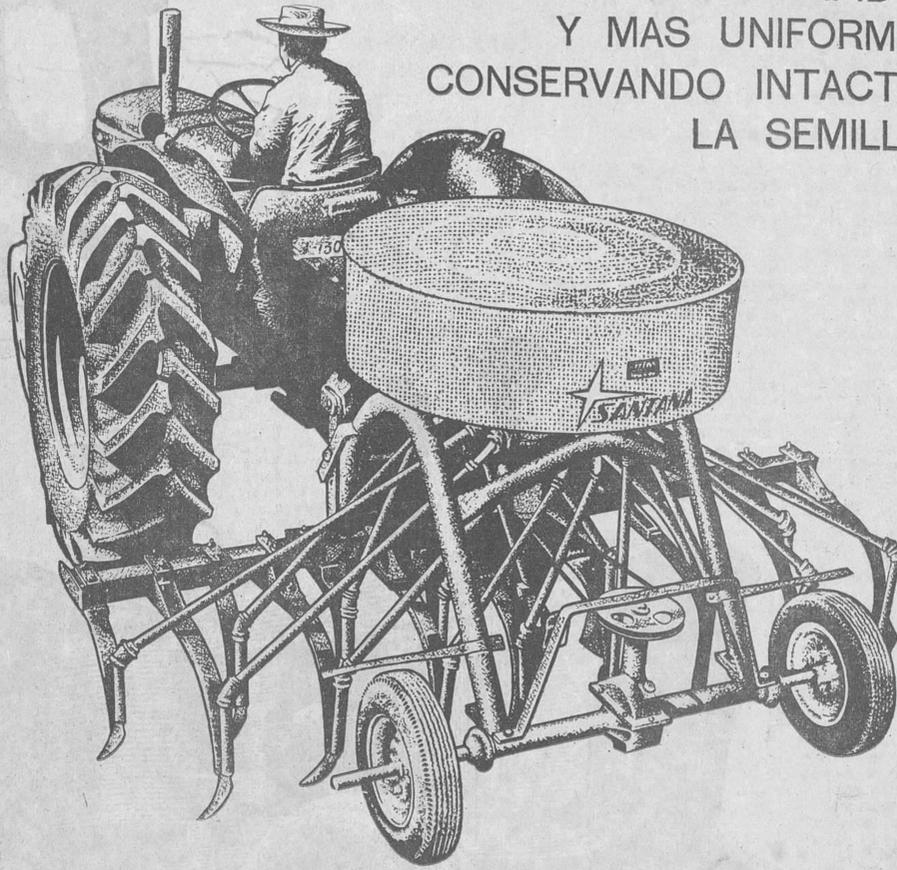
El sistema centrifugo de la sembradora SANTANA permite que la semilla se deposite uniformemente asegurando una perfecta distribución. La sembradora centrifuga SANTANA está especialmente concebida para sembrar toda clase de semillas.
