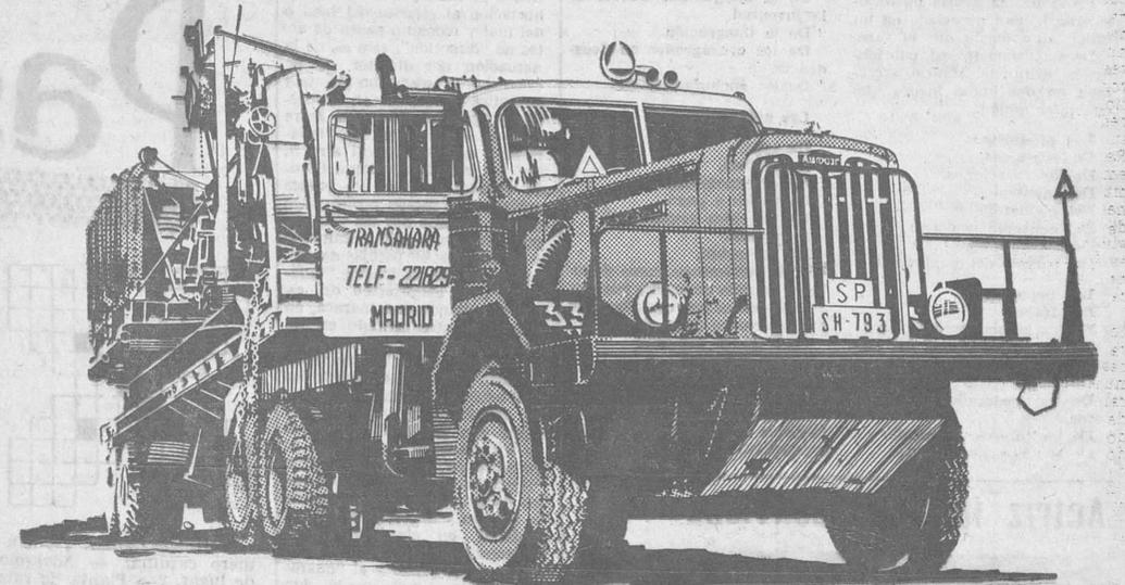
**TRACTO-CAMION AUTOCAR 220 H. P. Y SEMI-REMOLQUE PLATAFORMA DE 30 Tn. DE CAPACIDAD DE CARGA**
