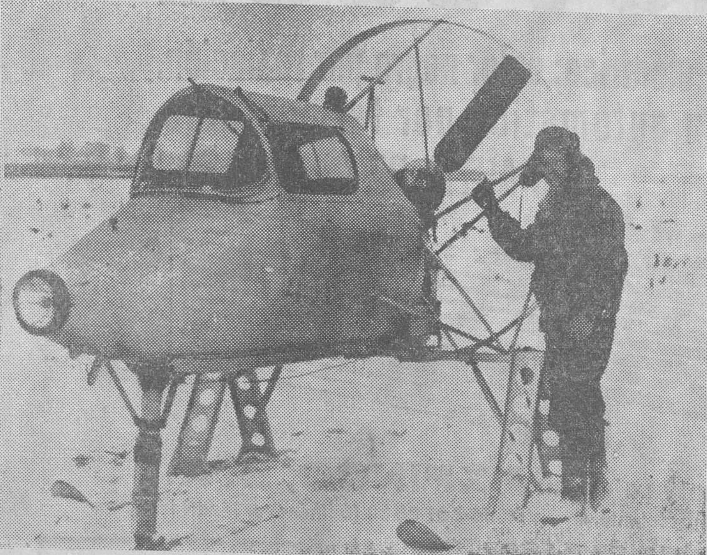
Andrei Blagovistny, que vive en el territorio de Primorye (URSS) y que pertenece al Iman Service Combine, ha diseñado y construido este aerotrino, al que ha adaptado un motor de dos cilindros y dos ejes de potencia. Está dotado de una gran hélice de madera dura y la cabina va cubierta con duraluminio y cristal orgánico. Andrei, que es cazador, podrá desplazarse así a mayores distancias que hasta ahora venía haciendo, ya que el aparato puede desarrollar una velocidad de 50 kilómetros por hora. En la foto le vemos con su invento. — (Foto Fiel)
