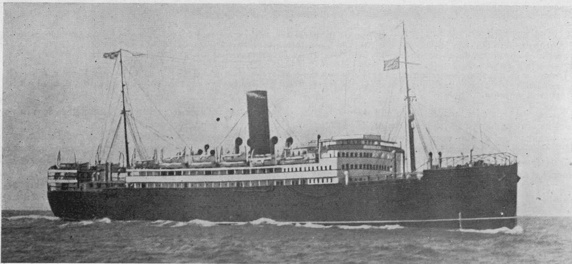
El hermoso trasatlántico “Cristóbal Colón”, con las características siguientes: eslora, 152-50; manga, 18-66; puntal, en la cubierta principal, 10-90; altura, hasta el puente de mando, 21-30; desplazamiento, 15,000 toneladas; velocidad, 18 nudos y dos hélices.
