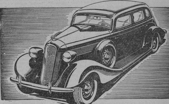
Los primeros coches con una suspensión independiente de las ruedas delanteras que proporciona la mayor comodidad, en el asiento delantero y trasero de un automóvil...
