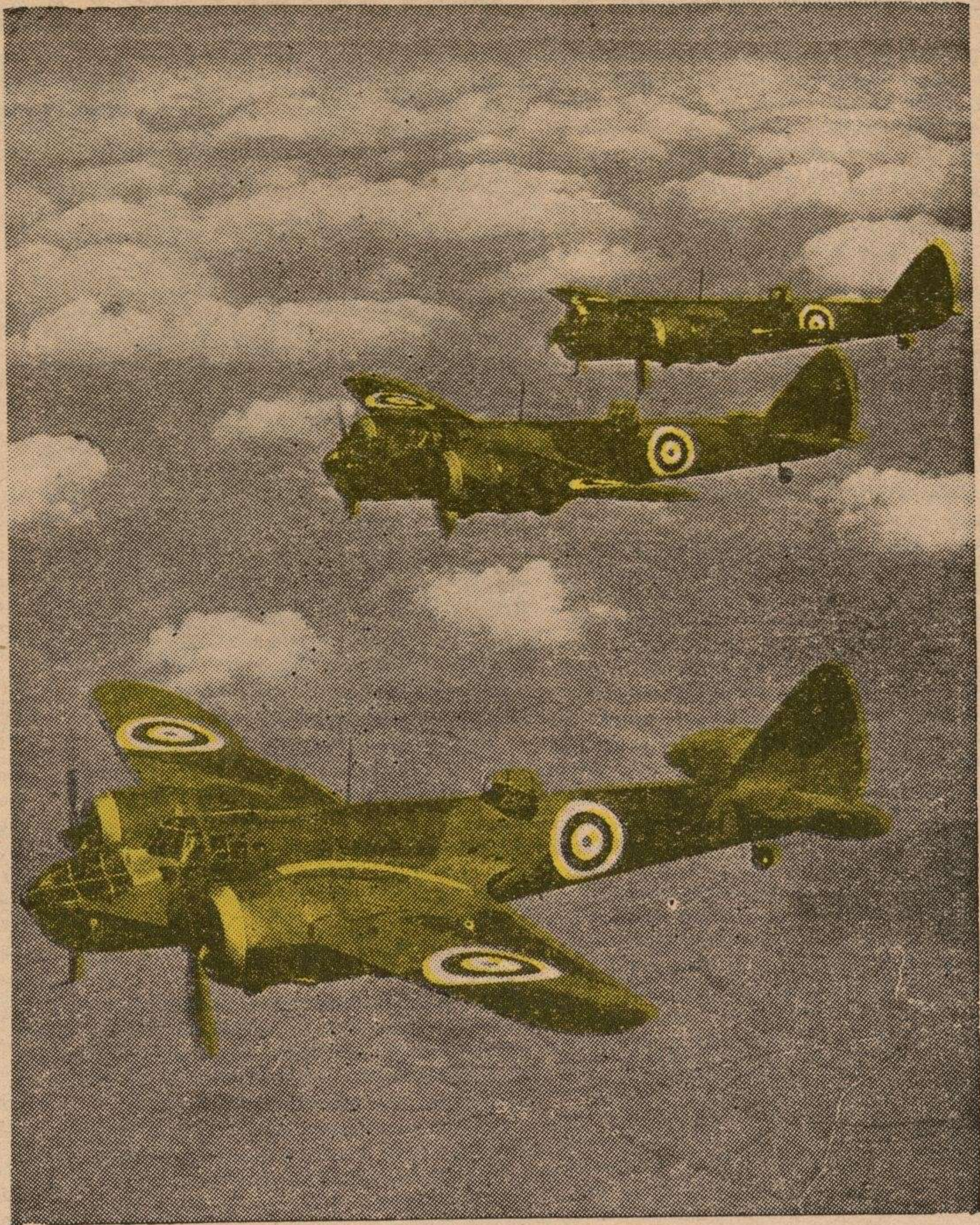
Parte de una escuadrilla Bristol «Blenheim», de bombardeo bimotore, considerados como la aportación más importante de la aviación inglesa en esta guerra. Pueden desarrollar una velocidad de 295 millas por hora, con un radio de acción de 1900 millas.
