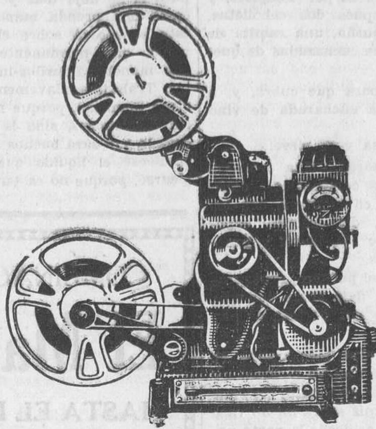
CINE PATHE "LUX", máxima luminosidad y firmeza absoluta, con dispositivo para películas de 100 metros, motor, amperímetro dispositivo de reembobinado y una bombilla tipo "O". Puede ser accionado con todas las corrientes: alternas 50 periodos y continuas de 90 a 130 voltios. Proyección perfecta desde 10 cms. a 25 metros. Cuadro máximo 2 X 3 metros: 850 pesetas.
