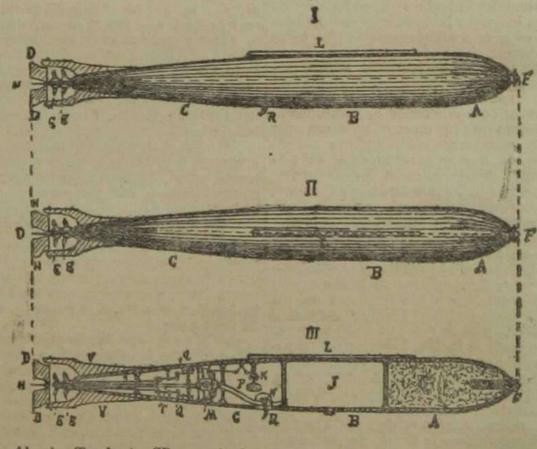
Alzada, (I); planta, (II), y corte longitudinal, (III), del torpedo alemán de aire comprimido sistema Schwartzkopff.
