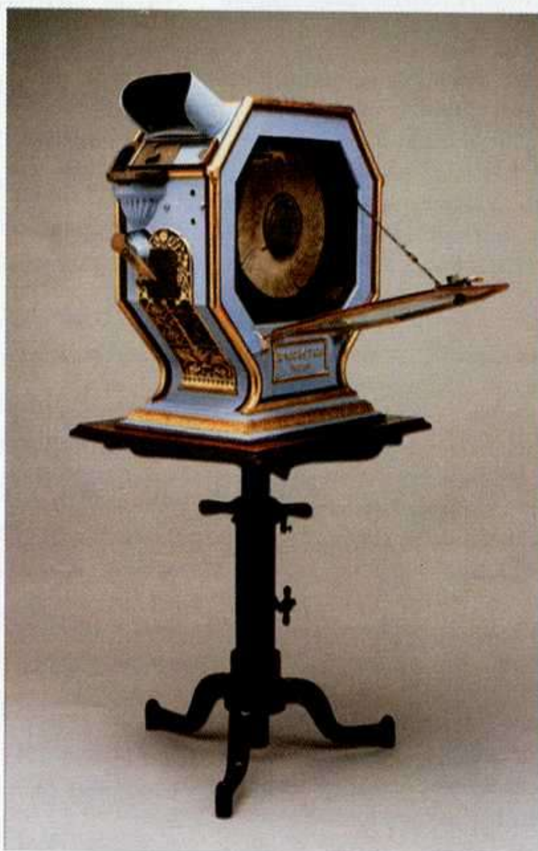
Mutoscopio de Dickson y Casler, concebido desde el principio como máquina tragaperras
