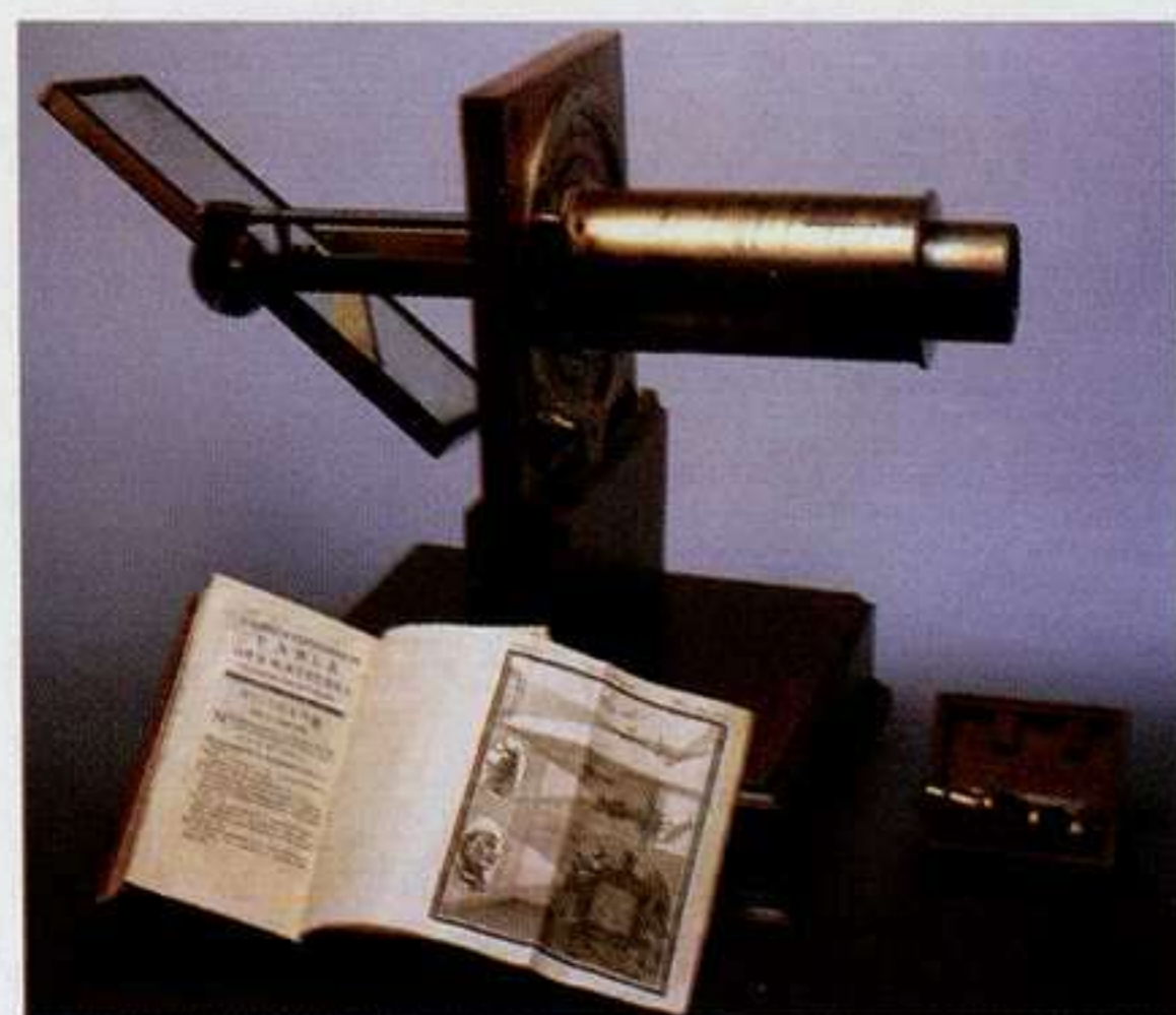
El microscopio solar utilizaba la luz del sol como fuente para proyectar cuerpos opacos de reducidas dimensiones
