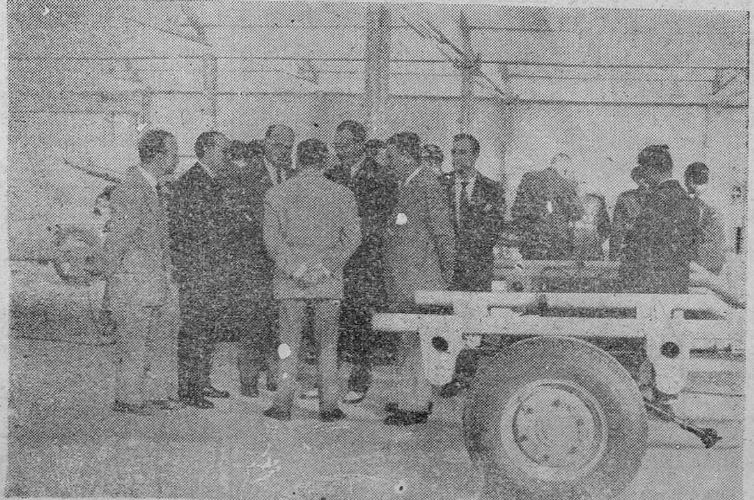
Este es el chasis que será convertido en un motocarro. El chasis es de tubo de acero con una distancia entre ejes de 2,45 metros y un ancho de vía de 1,54 metros.
