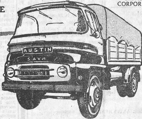
5,5 toneladas - Motor Diesel, 6 cilindros, 107 CV;
