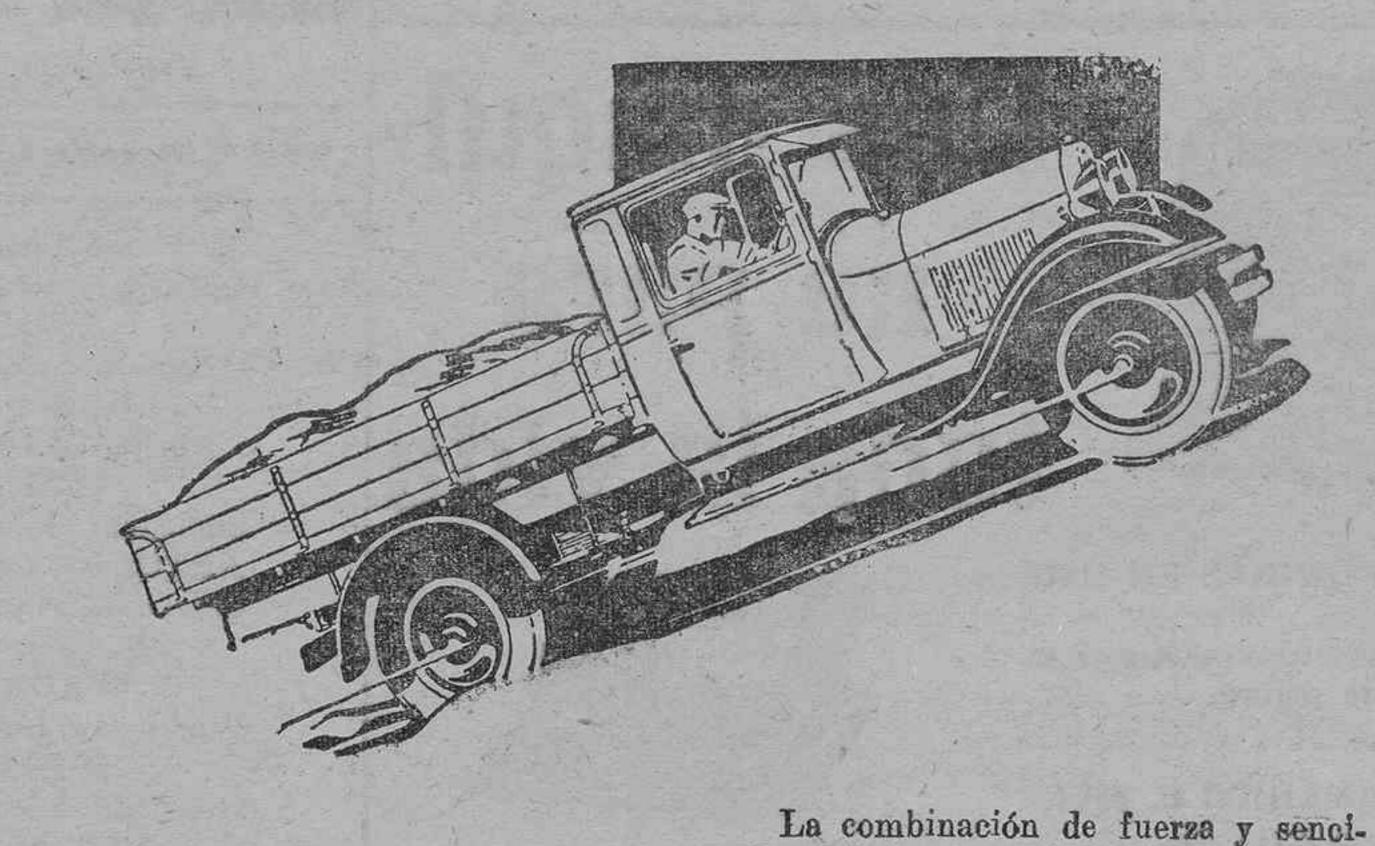
porte rápido, eficaz y a coste mínimo. Son muchas las características mecánicas que contribuyen a dichas condiciones. Bástenos citar una sola: el eje trasero—de esencial importancia provisto de engranajes cónicos en espiral, de tipo especial para camión, y con el eje del piñón de ataque montado sobre cojinetes cónicos... Favorézcanos con su visita y le describiremos
