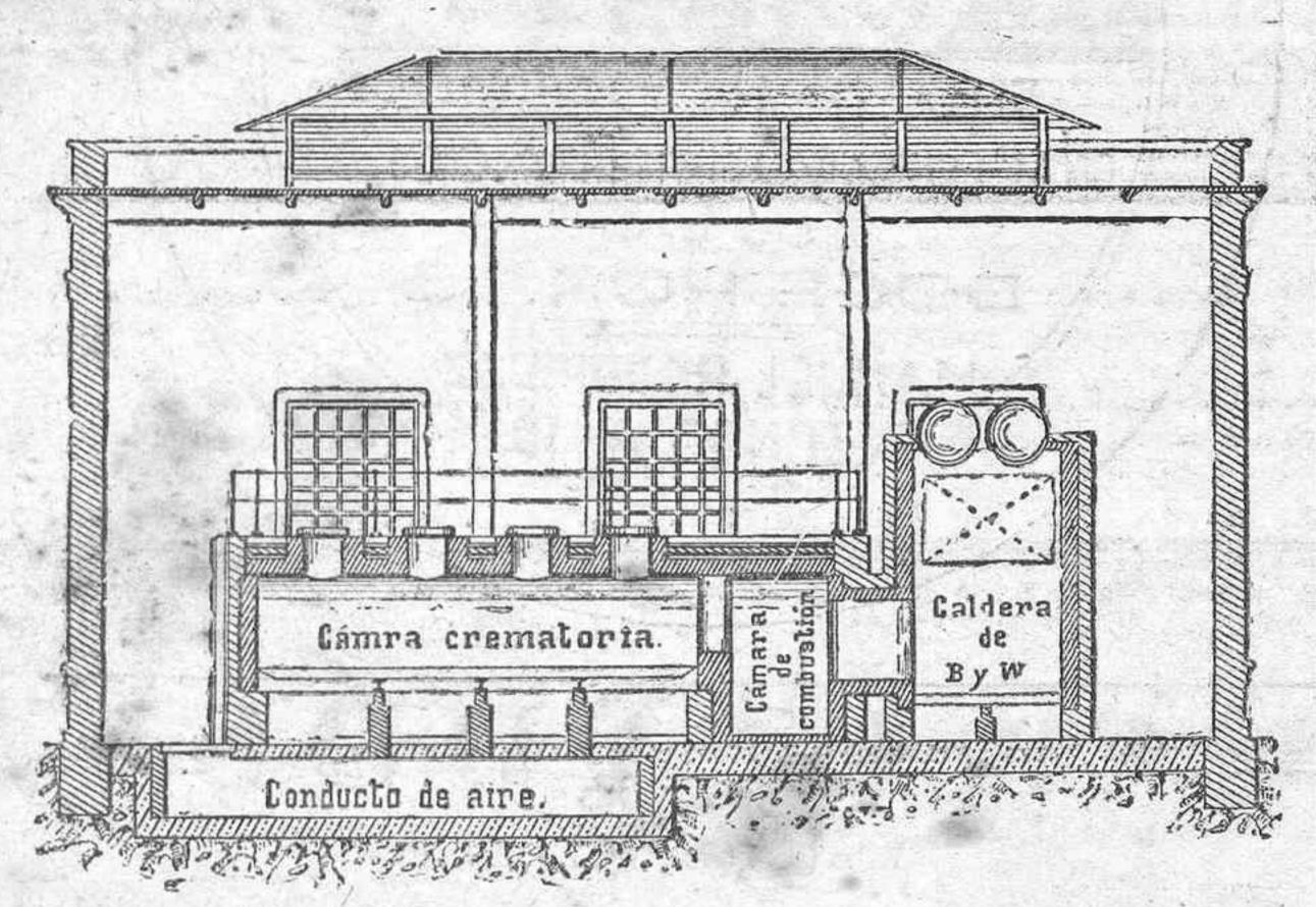
Sección longitudinal del edificio para el horno destinado a la cremación de basuras
