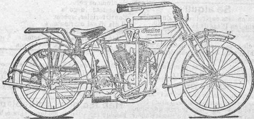
Dos cilindros con 7 HP nominales. Cuadro montado en muelles. Tres velocidades y embrague de discos secos múltiples. Carburador automático con chorro auxiliar para baja velocidad. Ruedas grandes (28 X 3), propias para estas carreteras.
