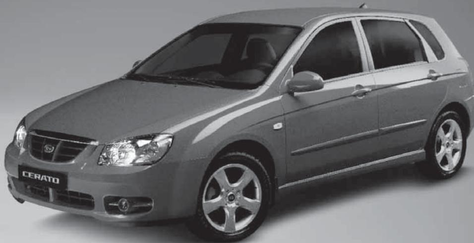
Motores Diesel 1.5 CRDI (102 CV) 2.0 CRDI (112 CV) / Motores gasolina 1.6 16V DOCH (105 CV) 2.0 16V DOCH (143 CV)
