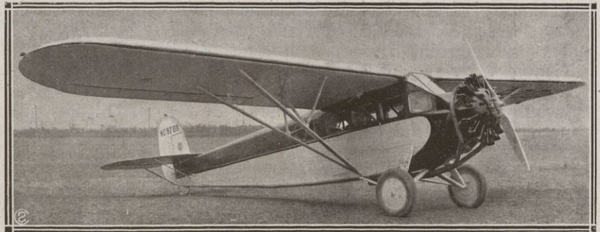
El majestuoso monoplano Fairchild, de siete pasajeros, modelo 71, de mayor renombre por haber volado en el MERCURIO. El punto saliente a un extremo del ala, es una de las luces de situación
