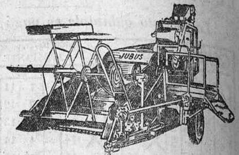
De 1,47 metros de corte para tractores desde 25 HP. Perfecta limpieza de grano. Máquinas en funcionamiento en España:
