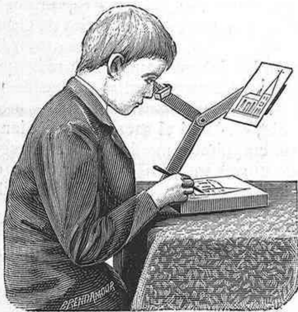
Fig. 2. - Modo de usar el dicatóptero
