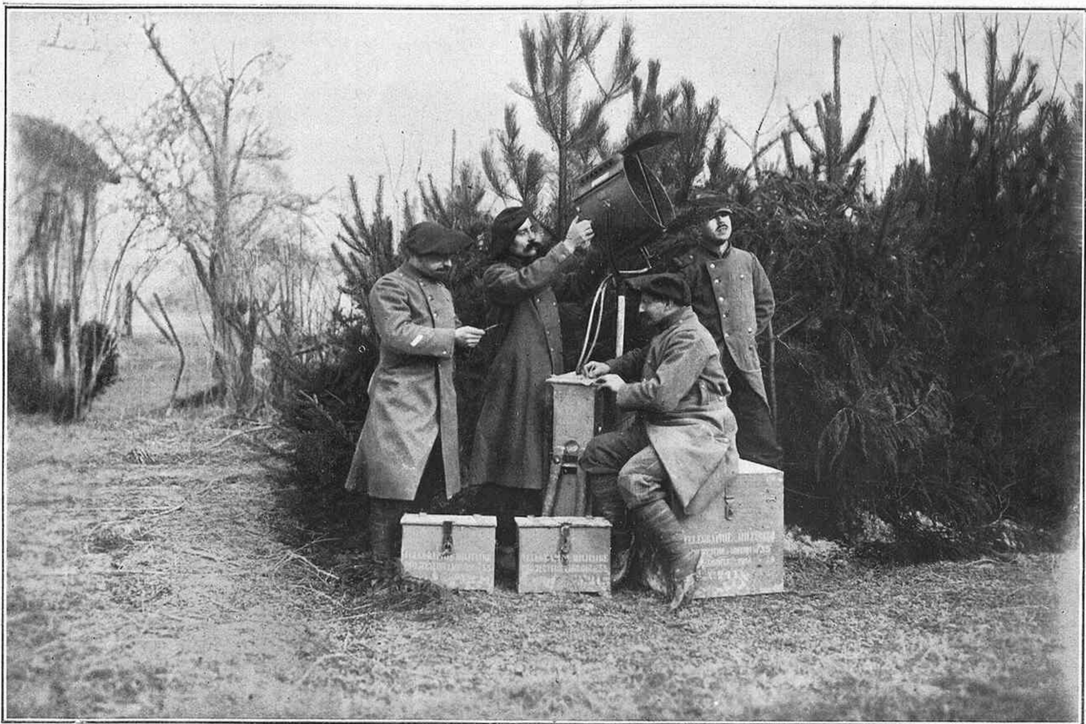
En el frente de batalla de la Champaña. — Cazadores alpinos telegrafando por medio de un proyector de espejo disimulado detrás de un grupo de abetos (De fotografía de M. Branger.)
