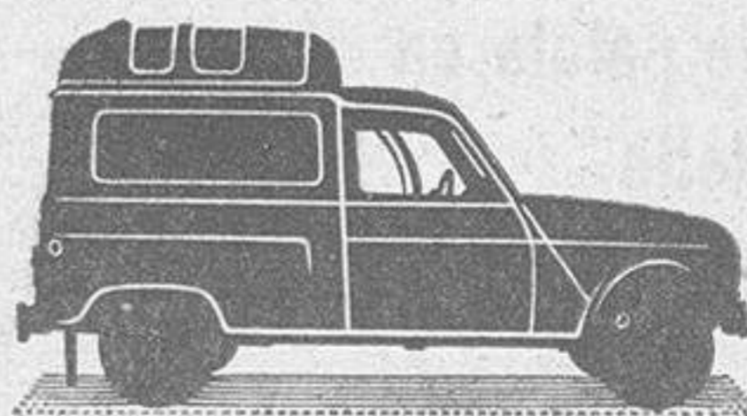
Sobreelevada Carga 425 kg. Altura útil 1,307 m. Volumen útil de carga 2,08 m 3
