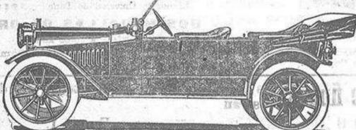
Torpedo de turismo, 5 asientos, 4 cilindros en bloc, 83 por 140, 32 HP. Embrague á discos metálicos. Magneto Bosch Carburador Zenith, 4 marchas (cambio por doble tren balador). Ingresas á presión automática. Suspensión, baja y sumamente cómoda, con juego completo de amortiguadores.
