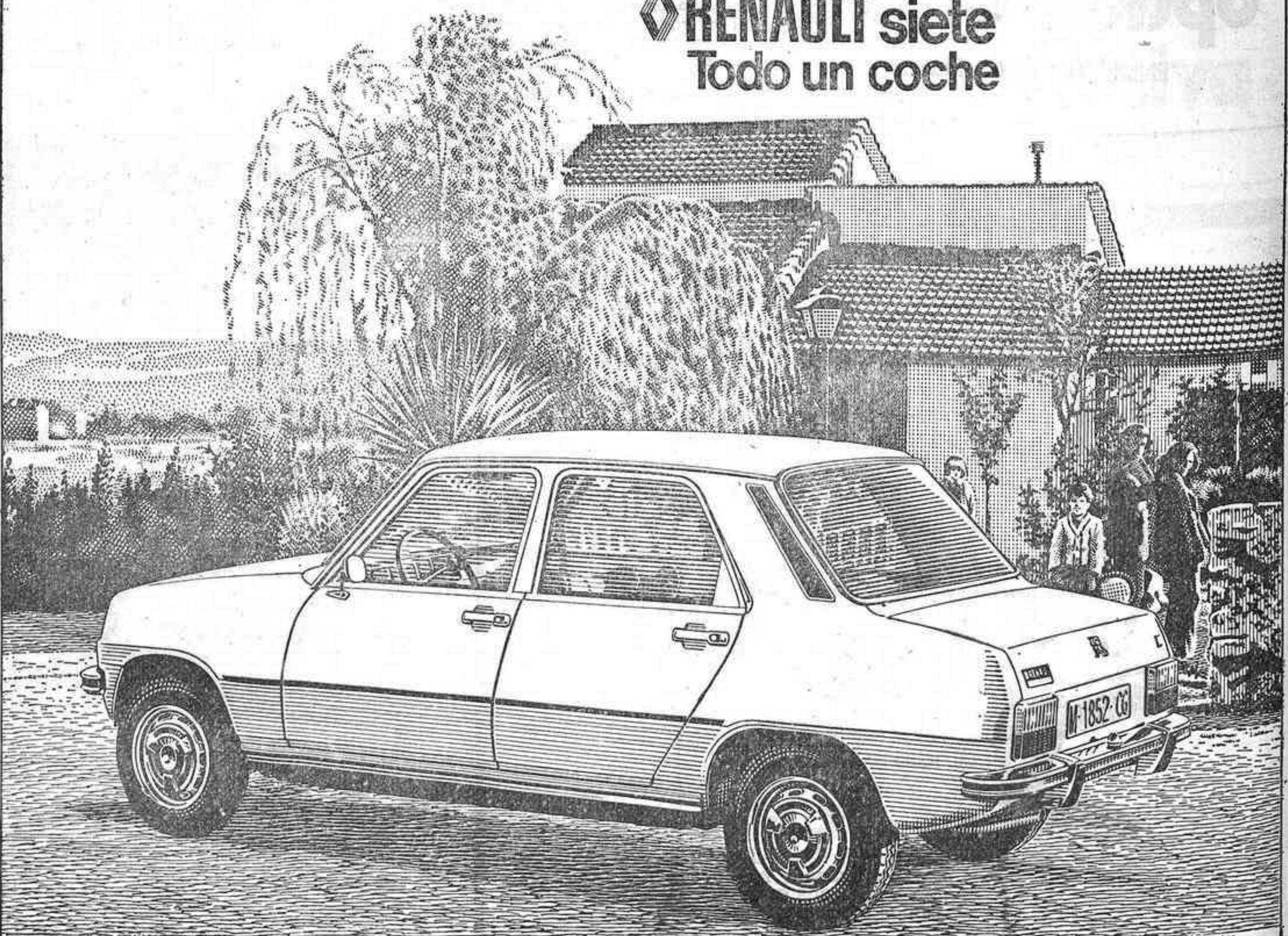
Motor Renault 1.037 cm 3 Tracción delantera. Suspensión por barras de torsión. Cuatro puertas.
