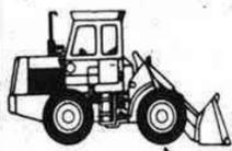
JD444: 85 HP.SAE. netos (63 KW) opciones de cucharas de 1,15 y 2,29 m. 5.822 kg. de carga basculante en vertical, altura de elevación de 3,40 m.
