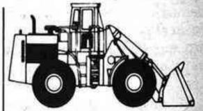
JD844: 260 HP.SAE. netos (194 KW), cinco opciones de cucharas de hasta 5,35 m. 17.443 kg. de carga basculante en vertical, altura de elevación 4,23 m.
