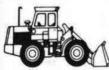
JD544-B: 105 HP.SAE. netos (79 KW), opciones de cucharas de 1,34, 1,53 y 2,29 m. 7.437 kg. de carga basculante en vertical, altura de elevación de 3,45 m.
