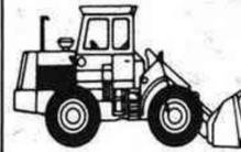
JD644-B: 145 HP.SAE. netos (108 KW), tres tamaños de cucharas 1,91, 2,29 y 3,44 m. 10.390 kg. de carga basculante en vertical, altura de elevación de 3,66 m.
