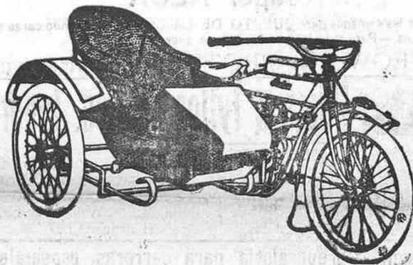
Dos cilindros con 7 H P nominales. Cuadro montado en muelles. Tres velocidades y embrague de discos secos múltiples. Carburador automático con chorro auxiliar para baja velocidad. Ruedas grandes (28 por 3), propias para estas carreteras.
