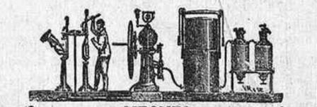
SIFONES de grande y pequeña palanca óvoides y cilindricos, ensayados á una presión de 20 atmósferas. Sencillos sólidos, fáciles de limpiar.
