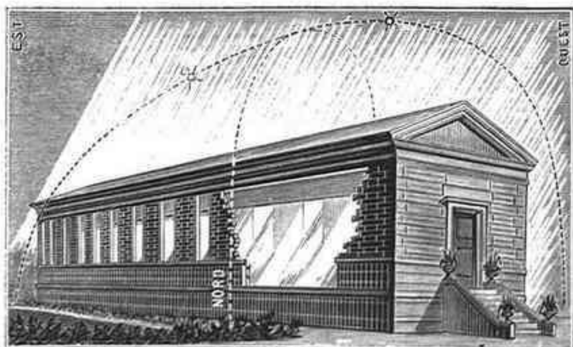
Fig. 9. - Orientación de las salas. - Países meridionales. - Orientación Norte-Sur. - Se suprime con ella la acción ofensiva de los rayos solares de la mañana y de la tarde que penetran horizontalmente en el interior de las salas
