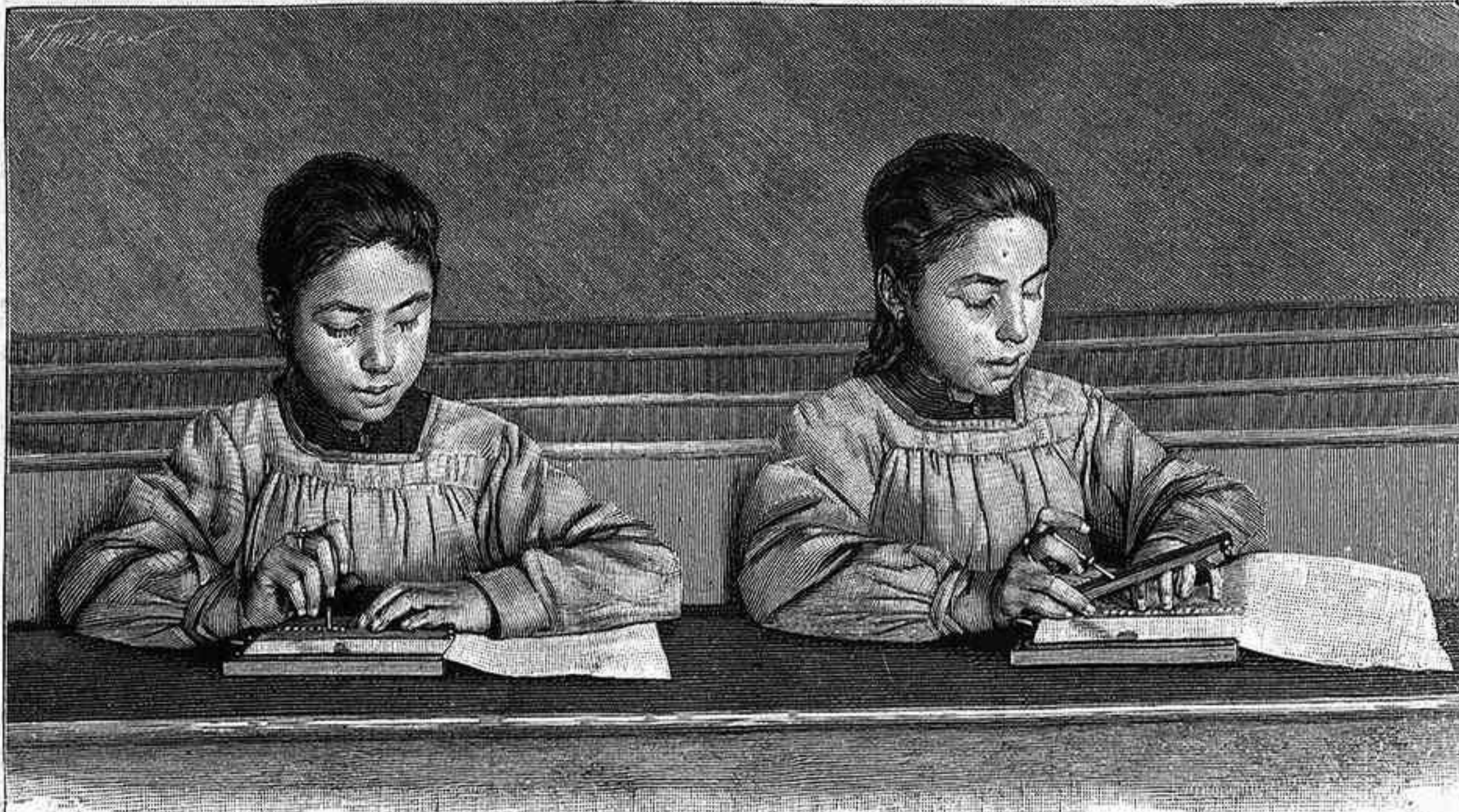
Fig. 1. - Aparato para escribir y calcular los ciegos. - La niña de la izquierda escribe con su punzón y la de la derecha tiene levantados el punzón y la regla que le sirve de guía
