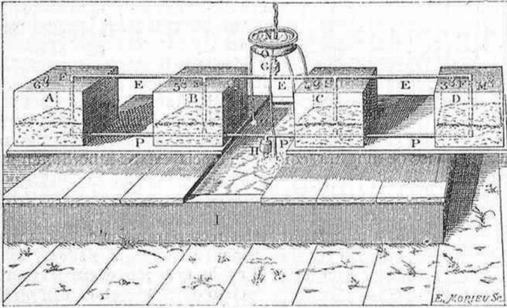
Fig. 1. Máquina en extremo sutil por medio de la cual podrá elevarse el agua estancada (según Salomón de Caus, 1624)
