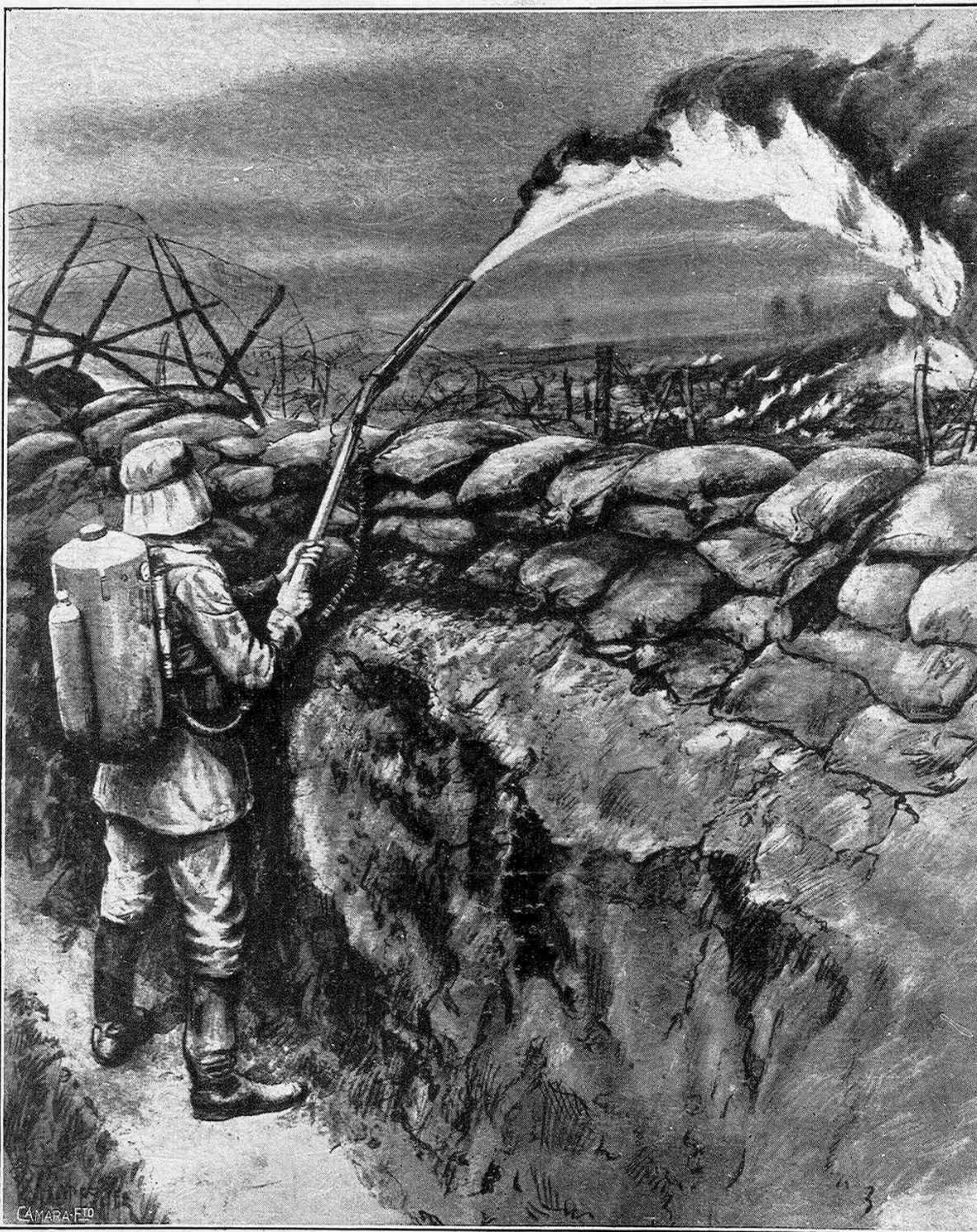
El proyector de fuego líquido, uno de los terribles inventos de la química alemana puestos al servicio de la guerra. El aparato llamado "Flammenwerfer" arroja á 30 metros el chorro de llamas. El líquido es una mezcla de "petróleo" y "kerosene"
