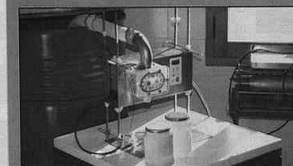
Una sencilla y práctica envasadora electrónica permite prefiar automáticamente la cantidad de miel que debe caer, en función de cada frasco. La miel está lista para ser etiquetada y almacenada, rumbo a las tiendas. La cata ha terminado.
