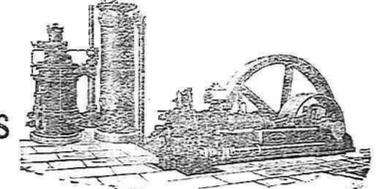
Motor de gas pobre con gasógeno.
