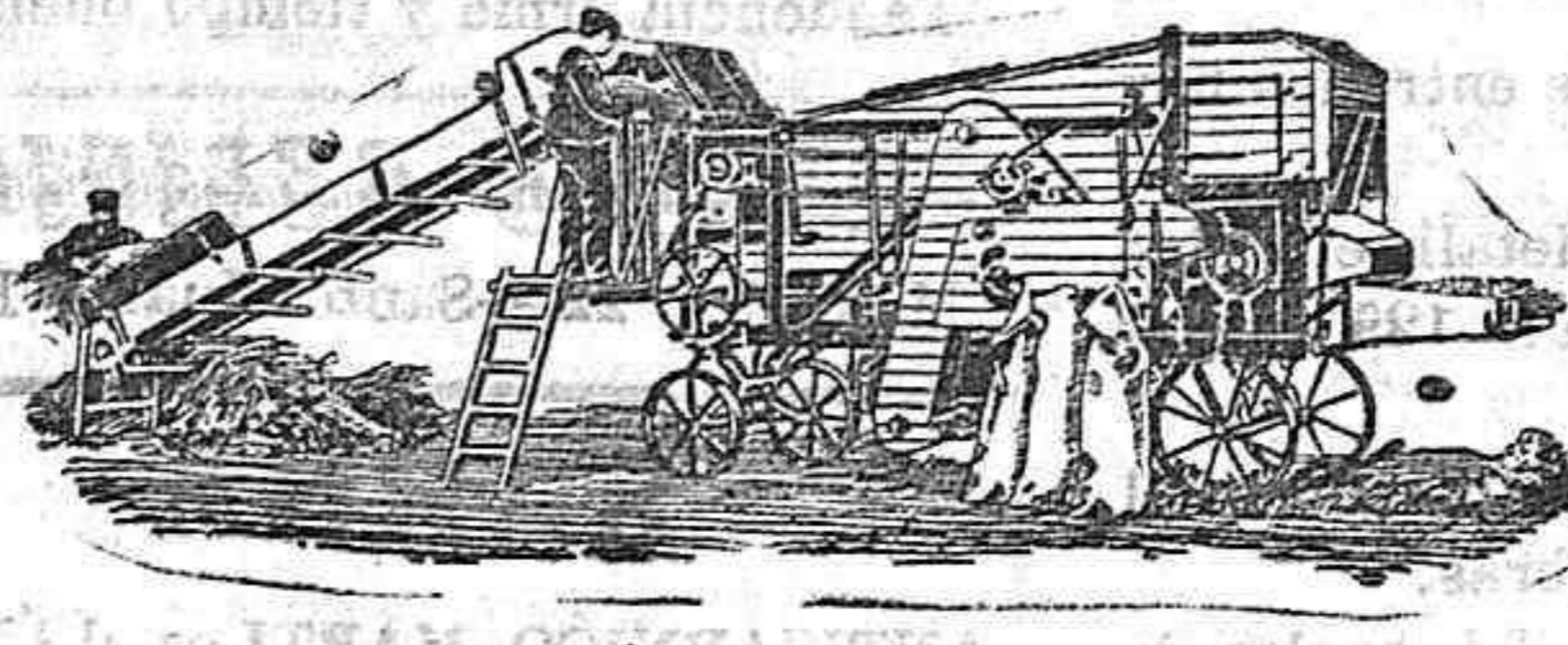
Trilladora «Triunfo Grande» con elevador de mies. Rendimiento diario de 150 a 200 fanegas de trigo, según granazón.
