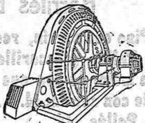
Generador de corriente alterna,
