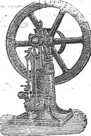
En estos motores se ha suprimido el reparador efectuándose la entrada de gas y aire por válvulas.
