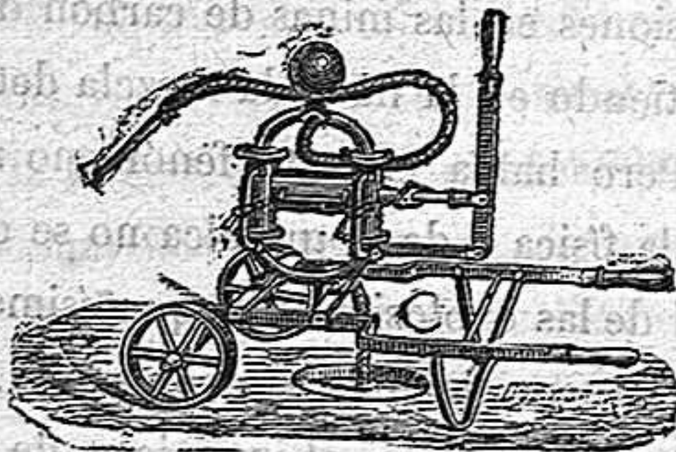
Bomba para riegos.
