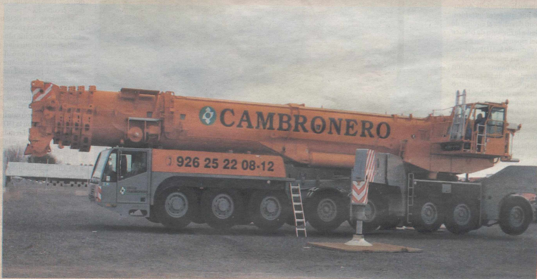
Grúa DEMAG AC 500/2 de 500 Toneladas
