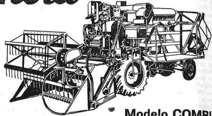
Modelo COMBI de 2,10 m. de corte con motor Fordson de 49 HP.
