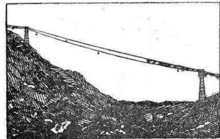
Instalación de funiculares aéreos para el transporte de frutos, materiales de empaque, limpieza de embalses etc.
