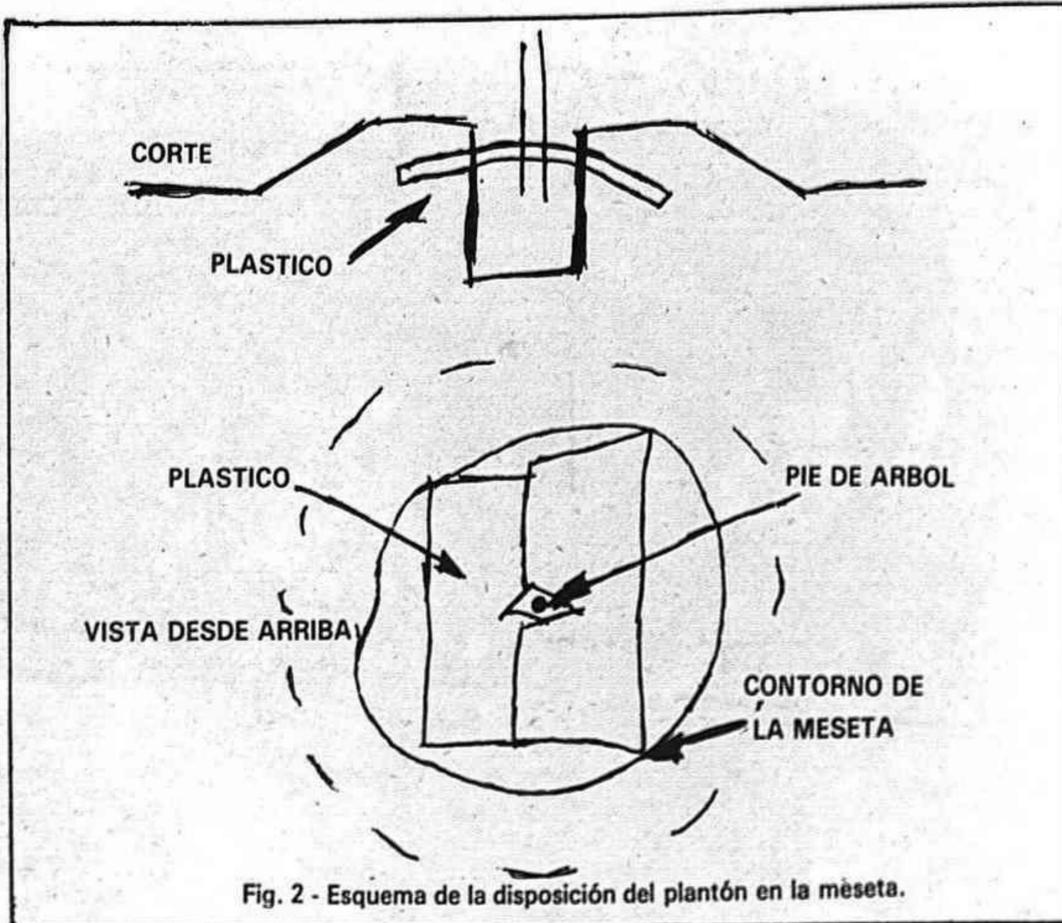
Fig. 2 - Esquema de la disposición del plantón en la meseta.
