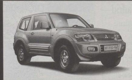
Transmisión Super Select SS4-II. Motores DI-D 3.2 de 165 cv y GDI 3.5 de 202 cv, y versiones con cambio automático Invecs II Sports Mode 5 A/T. Climatizador, doble airbag, ABS opcional.
