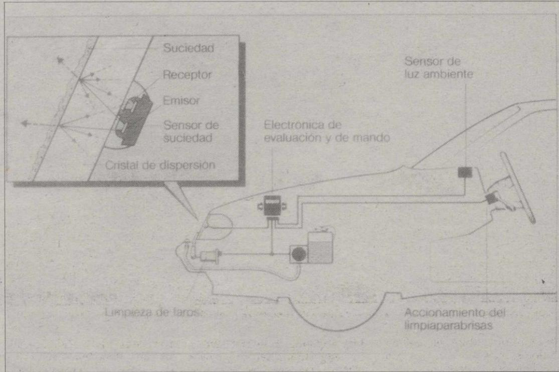
Equipo auto-limpiante de faros desarrollado por Bosch, un ejemplo de la adaptación de la electrónica al automóvil.
