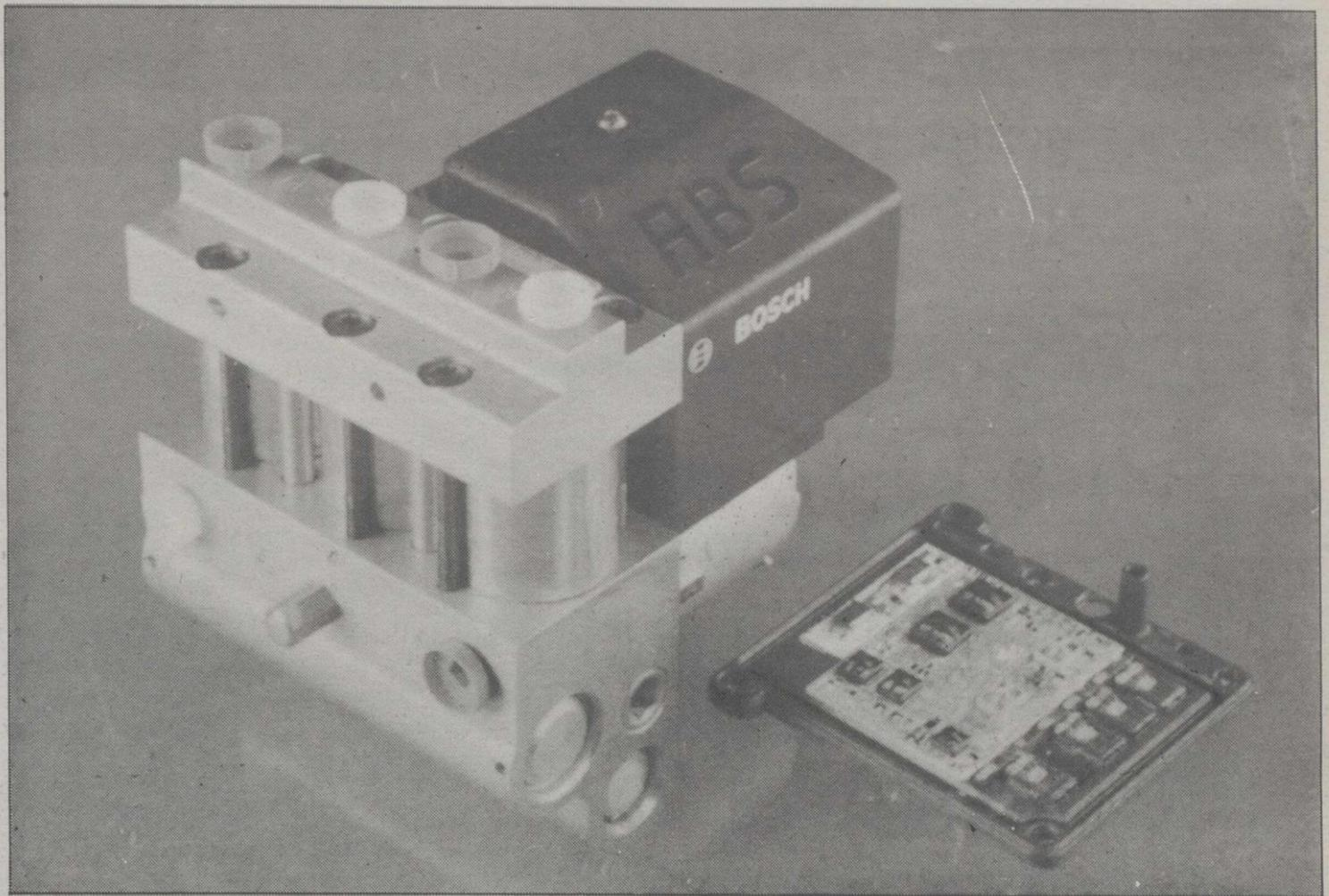
Grupo hidráulico del sistema ABS y aparato de mando integrado en técnica híbrida desarrollado por Bosch.
