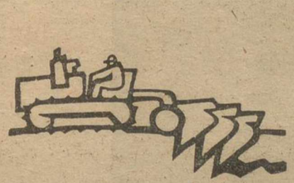
Quando se debe arar profundo y con grandes apelas, interesa un oruga (le da un rendimiento que ningún otro tractor puede darle)
