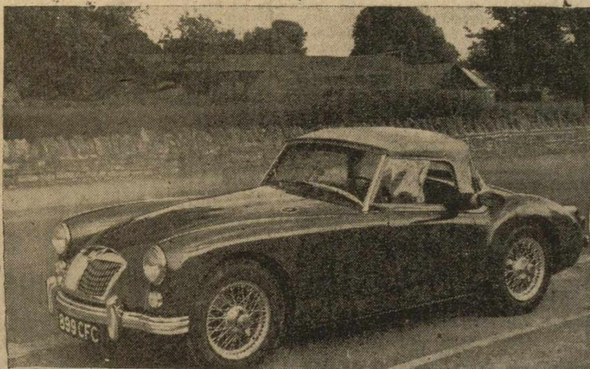
Con el objeto de aumentar la potencia de propulsión y de frenaje, se ha modificado el diseño del popular coche sport británico M.G.A. La cilindrada del motor ha sido ampliada desde menos de 1.500 c.c. hasta 1.588 c.c., lo cual, junto con otras innovaciones, ha incrementado la potencia hasta 79,5 caballos al freno a 5.600 r.p.m., consiguiéndose así una velocidad máxima de 160 k.p.h. y una velocidad de crucero de 128 k.p.h.
